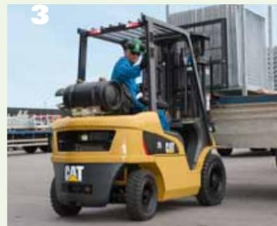
3. Las carretillas contrapesadas Cat® GP15-35N con motor GLP están equipadas con un limpio y económico catalizador de tres vías con control de circuito cerrado. Sus tres funciones clave son convertir el óxido de nitrógeno tóxico en nitrógeno y oxígeno; el monóxido de carbono en dióxido de carbono; y los hidrocarburos en dióxido de carbono y agua. El sistema de circuito cerrado asegura la mezcla óptima de aire y combustible en todo momento.
