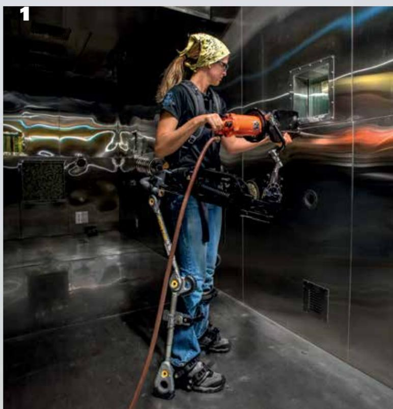
1. El exoesqueleto sin batería de Lockheed Martin sustrae el peso de una carga como la de herramientas pesadas y actualmente está a prueba en la marina de los Estados Unidos.
